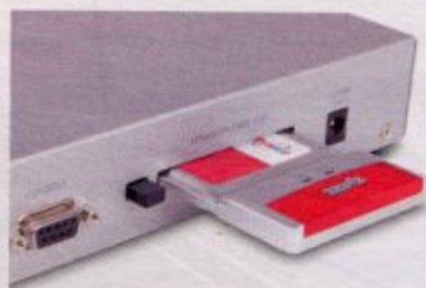
IDS, Virens Scanner und Spamfilter werden bei Zyxel über die Turbocard nachgerüstet
