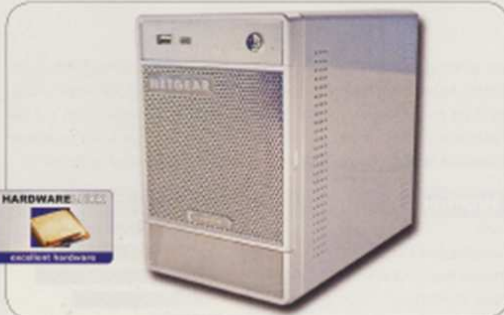
Flott: Netgears ReadyNAS NV+ zeigt mit mehr als 20 MByte/s wo es lang geht. Bei erstklassigem Funktionsumfang stört der laute Lüfter.
