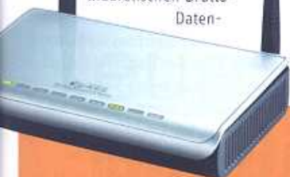
Zyxels MIMO-Router verfügt insgesamt über vier Antennen; zwei davon sind fix ins Gehäuse integriert, zwei sind beweglich.
