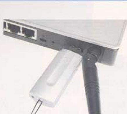
Zyxel: Für breite USB-Sticks ist kein Platz neben der Antenne
