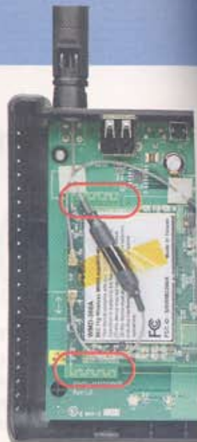
Zyxel: Die zwei mäanderförmigen Leiterzüge auf dem Funkmodul sind interne Antennen
