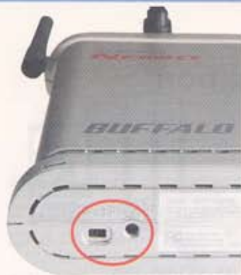
Per Schalter lässt sich der Buffalo zur WLAN-Bridge umfunktionieren
